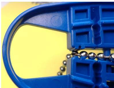
Posizionamento del perno nella sfera, chiusura della pinza e realizzazione della giunzione
